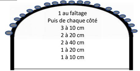
Exemple de pose sur une serre pied droit en largeur 4m. Total 19 fils.
